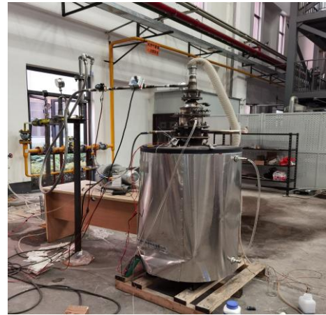
图9 浙江大学水冷预混燃烧器实验室研究试验系统照片
