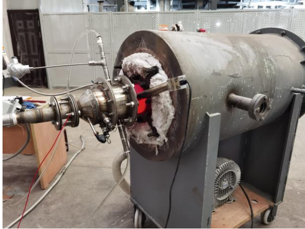
图9 浙江大学水冷预混燃烧器实验室研究试验系统照片
