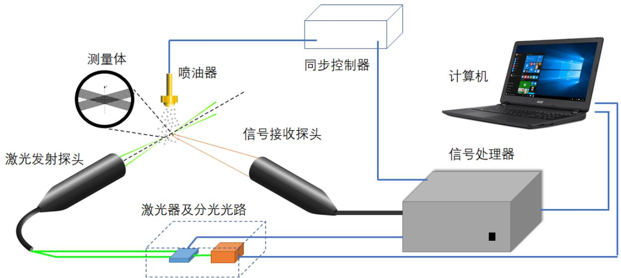
图 2 相位多普勒测试系统示意图
