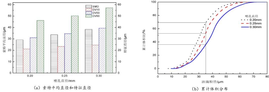
图4 不同喷口直径条件下喷雾雾化特性
