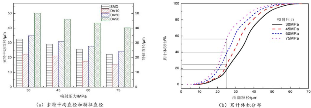
图3 不同喷射压力条件下喷雾雾化特性
